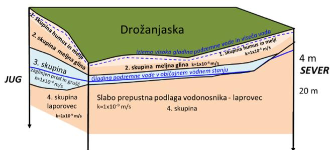
Slika 7: Hidrogeološki konceptualni model območja OPPN (vir: Geološko geomehansko poročilo in hidrogeološko poročilo št. DN 2006727, marec 2020)
