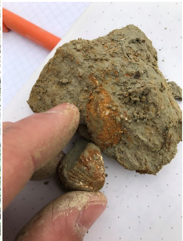
Slika 38: Ostanek školjke v plasti mastne gline, na globini med 1,5 in 4,5 m (desno)
