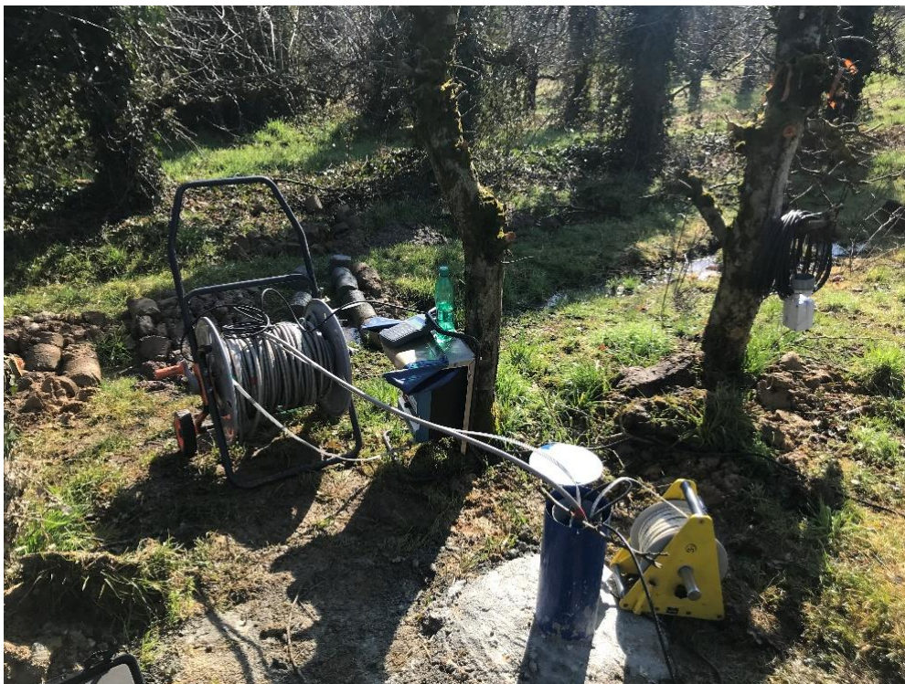
Slika 26: Potek črpalnega preizkusa v vrtini DR-8P/20
