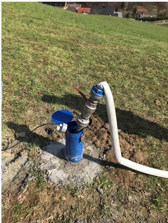
Slika 22: Izvedba nalivalnega preizkusa v vrtini DR-7P/20
