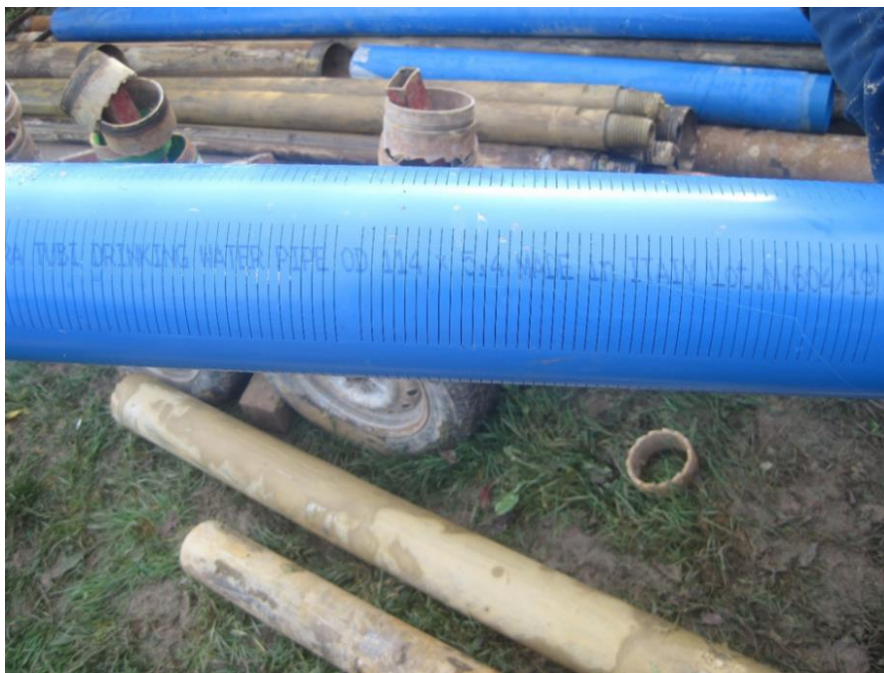
Slika 2: Tip PVC cevi, ki so vgrajene v vse opazovalne vrtine (piezometre)
