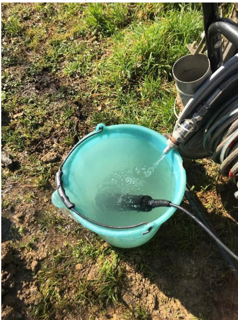
Slika 27: Ročne meritve fizikalno kemijskih parametrov podzemne vode
