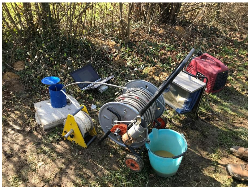
Slika 5: Potek črpalnega preizkusa v vrtini DR-2P/19
