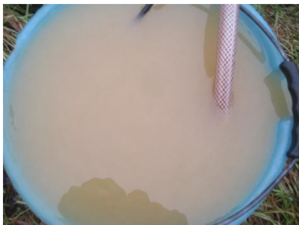
Slika 12 (leva slika): Začetek črpanja: kalna voda
