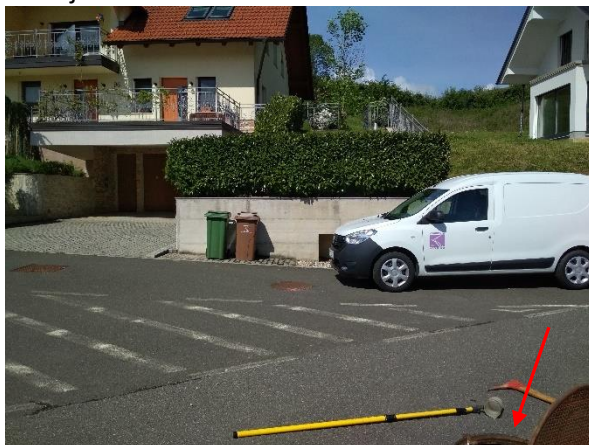
Slika 68 (desna slika): Odprt pokrov jaška M 2-7 s posodico za merjenje pretoka
