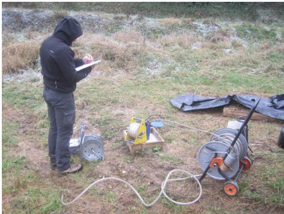
Slika 11: Črpalni preizkus v vrtini DR-3P/19
