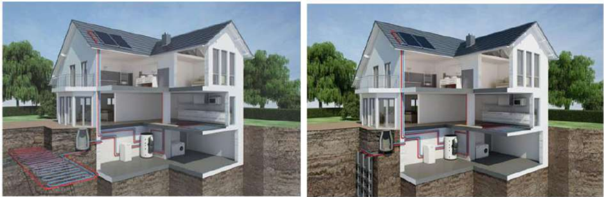
Slika 9.20: Izkoriščanje toplote zemljine. (VIR: Varčujem z energijo, 18 December 2020)
