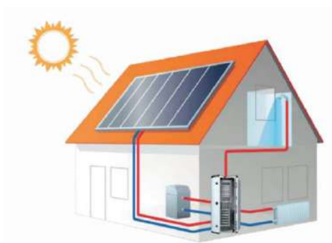
Slika 9.7: Na levi strani prikaz ogrevanja in priprava tople sanitarne vode v kombinaciji s sončnimi kolektorji, ter desno prikaz toplozračnih sončnih kolektorjev.
