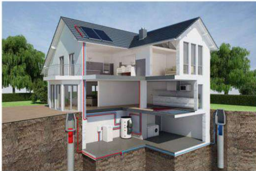
Slika 9.21: Prikazuje izkoriščanje toplote iz podtalne vode. (VIR: Varčujem z energijo, 18 December 2020)
