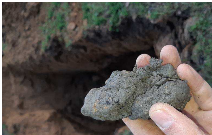
Slika 8: Mehka glina v razkopu R2.
