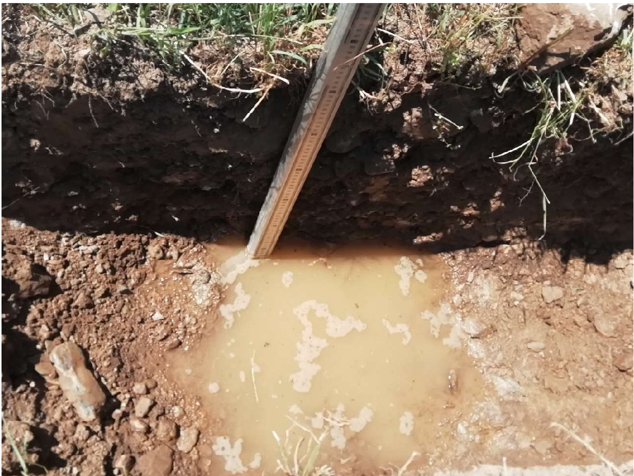
Slika 13: Hitri infiltracijski test v razkopu SR 2
