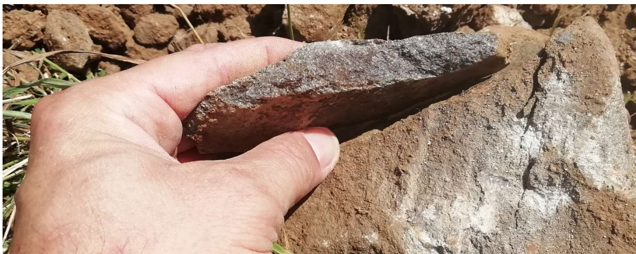
Slika 12: Preperel peščenjak iz razkopa SR 2
