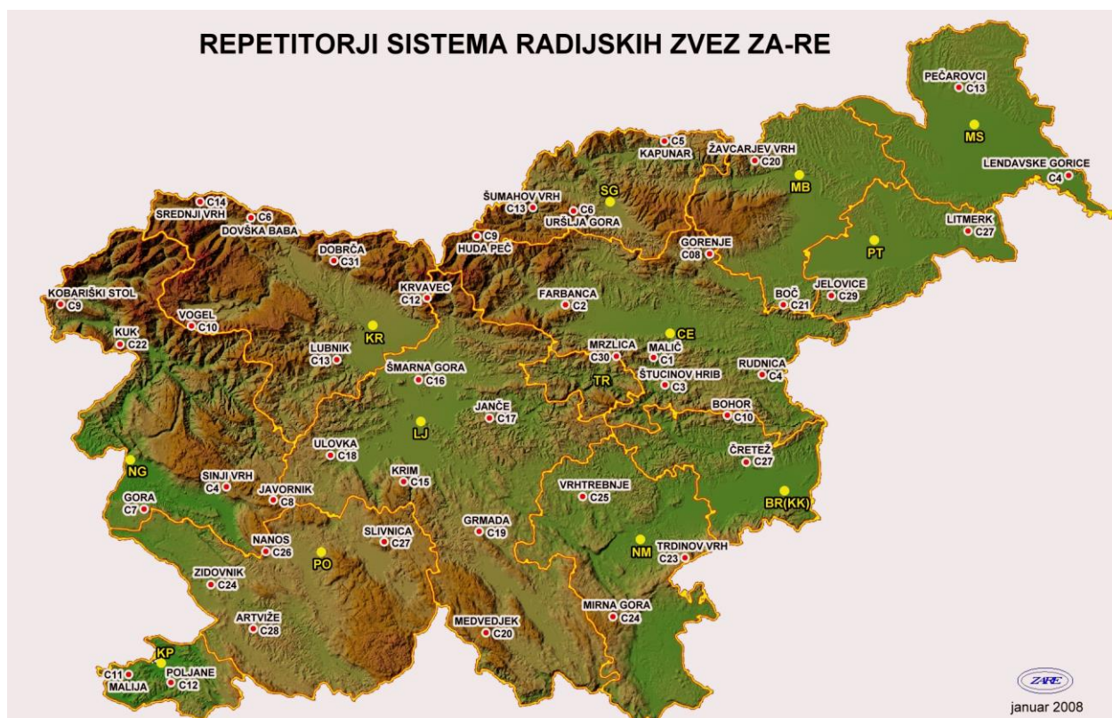
Slika 8: Repetitorske postaje s kanali sistema ZA-RE
