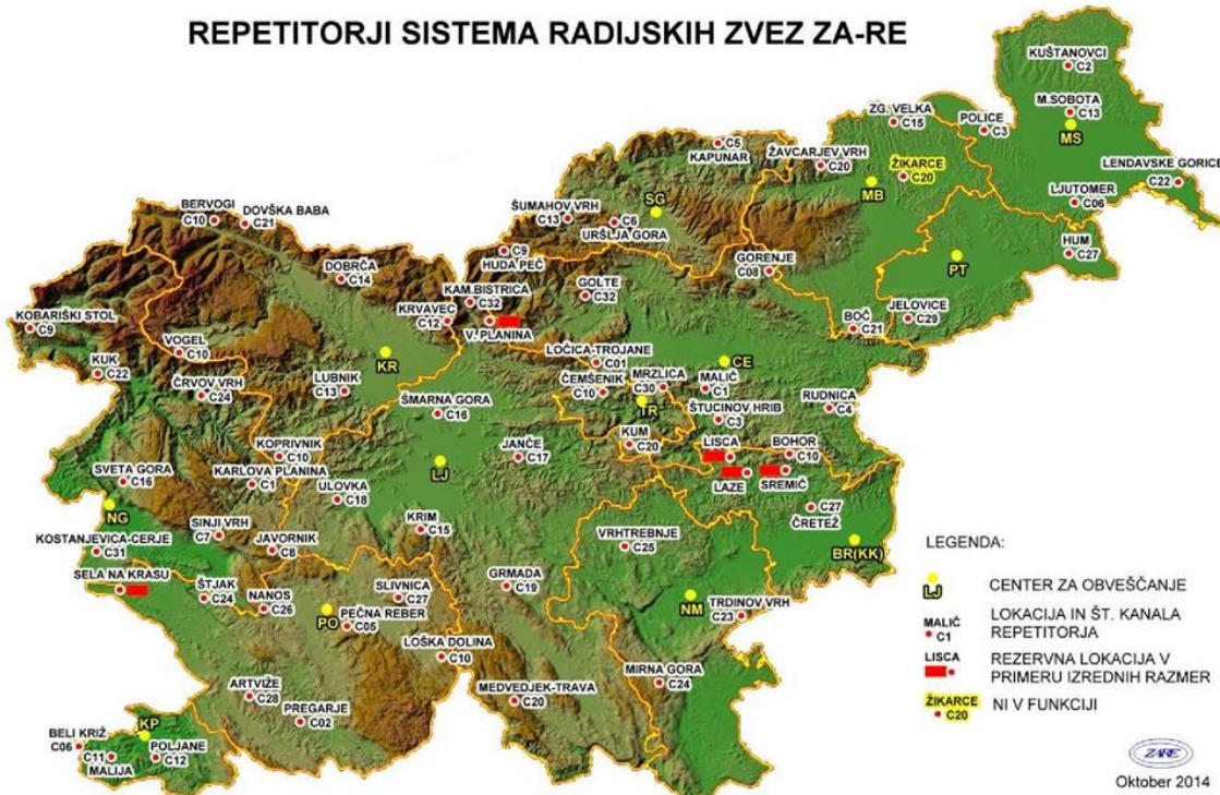
Slika 4: Repetitorske postaje s kanali sistema ZA-RE
