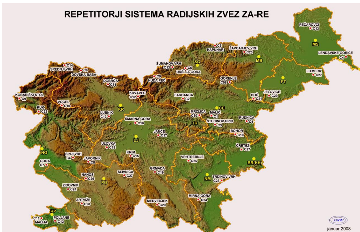
Slika 8: Repetitorske postaje s kanali sistema ZA-RE
